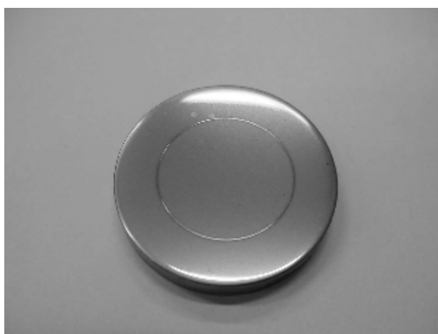
Figura 6. Proba A4 în urma testelor de uzare Figure 6. Sample A4 after the wear test
