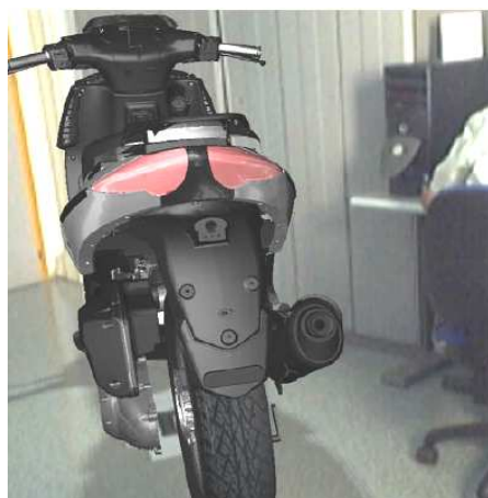
Figura 4. ARBike : sistem de RA pentru validarea estetică a motocicletei Figure 4. ARBike : AR system for supporting the aesthetical validation of a motorcycle
