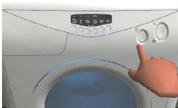
Figura 3. VRWashMachine : sistem RV pentru validarea modului de utilizare a unei mașini de spălat Figure 3. VRWashMachine : VR system for supporting the usability validation of a washing machine
