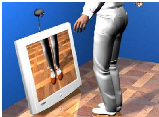
Figura 6. MagicMirror : sistem de RA pentru concepția și testarea unui produs personalizat de tip pantofi
