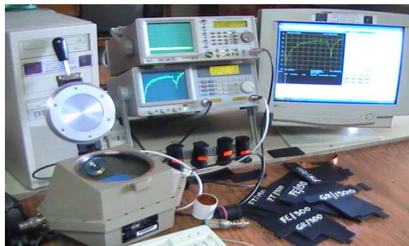
Figura 4. Detaliu asupra sistemului de măsură cu incinta TEM
