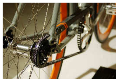
Figura 13. Transmisie cu curea la o bicicletă modernă Figure 13. Belt transmission of a modern bicycle
