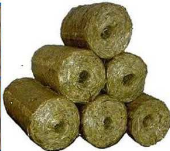
Figura 2. Peleți și brichete cu gol interior [9] Figure 2. Pellets and briquettes with inner hole [9]
