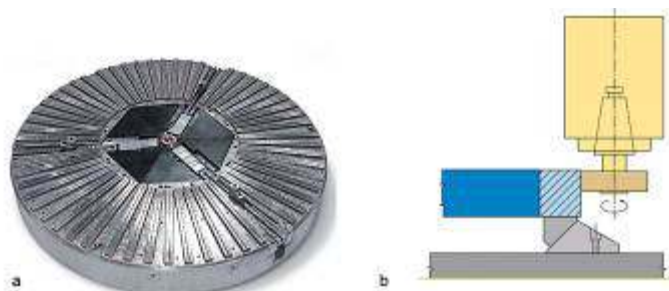
Figura 10. a) Mandrină combinată cu MPE și sistem mecanic autocentrant; b) metoda de centrare cu rolă [7] Figure 10. a) Combi chuck EPM and mechanical self-centring system; b) centering method with a roll [7]
