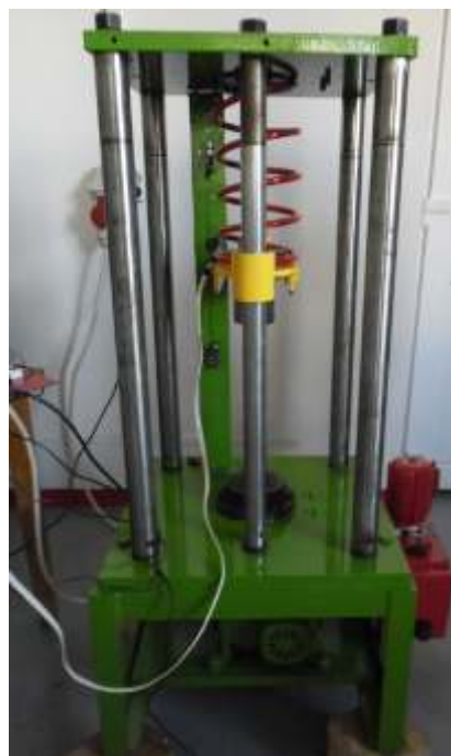
Figura 1. Schema cinematică și modelul experimental al unei prese de vulcanizat mecanice cu un singur șurub Figure 1. Kinematical scheme and the experimental model of a mechanical vulcanizing press with a single screw
