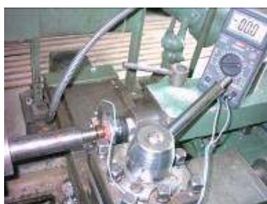
Figure 2. Installation for measuring the electrical thermocurrent at turning Figura 2. Instalație pentru măsurarea termocurentului electric la strunjire
