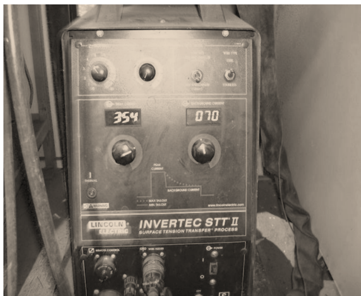
Figure 1. Utilised welding power source – INVERTEC STT Figura 1. Sursa de sudare utilizată – INVERTEC STT
