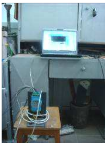
Figure 5. The equipment used for measuring and recording the temperature in casting Figura 5. Instalația utilizată pentru măsurarea și înregistrarea temperaturii în piesa turnată
