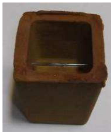
Figure 2. Mould for thermal analysis (foto) Figura 2. Forma de turnare pentru analiză termică (foto)
