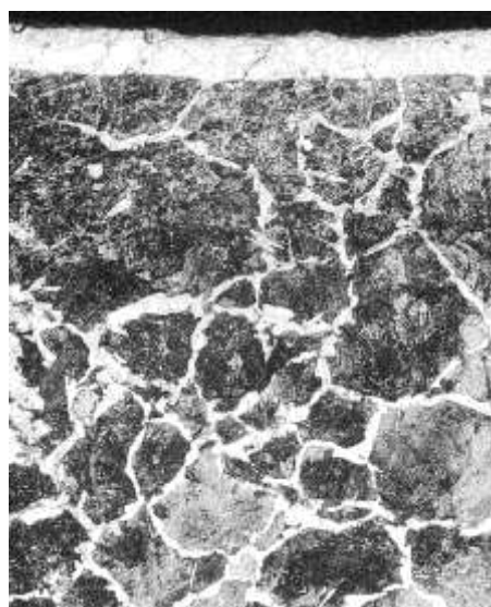
Figure 1. The microstructure of the siliconized steel in powder medium whit paste at 1150 °C, three hours Figura 1. Microstructura oțelului silicizat în mediu pulverulent cu pastă la 1150 °C, trei ore
