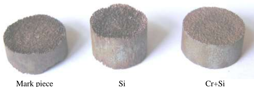
Figure 6. The aspects of samples after the test in HCl (2N) acid Figura 6. Aspectul pieselor încercate în HCl (2N)
