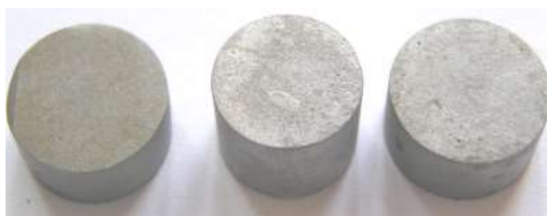
Mark piece Si Cr+Si Figure 8. The aspects of samples after the test in HNO 3 (2N) acid Figura 8. Aspectul pieselor încercate în HNO 3 (2N)
