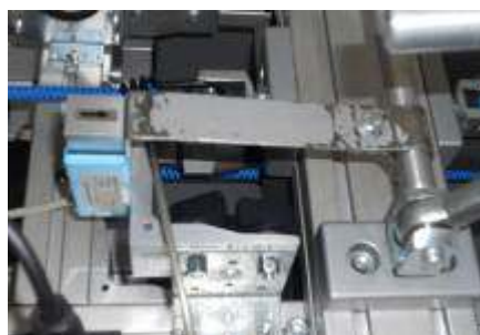
Figura 2. Amplasarea traductorului de forță pe echipament
