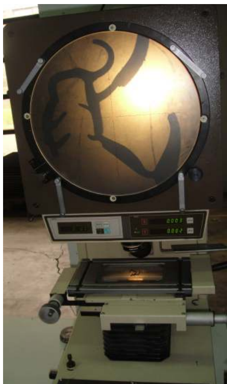
Figura 4: Metoda de analiza a conturului profilului Figure 4: Analysis method for profile contour
